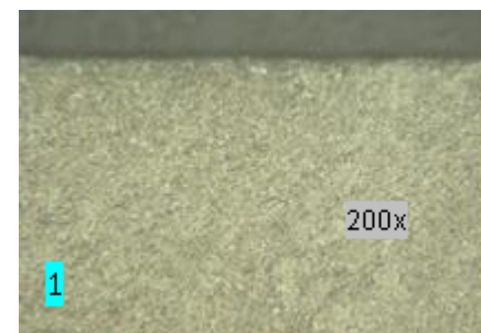
Gambar 14. Mikrograf sampel 3 dari batang piston sepeda motor kode Original. Pembesaran 200x dan Etsa: nital 2%
